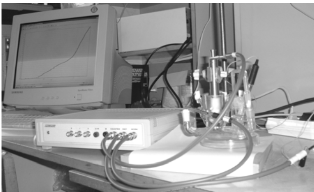
Рисунок 2 – Трьохелектродна електрохімічна комірка, під'єднана до потенціостата ІРС-Pro, керованого комп'ютером
