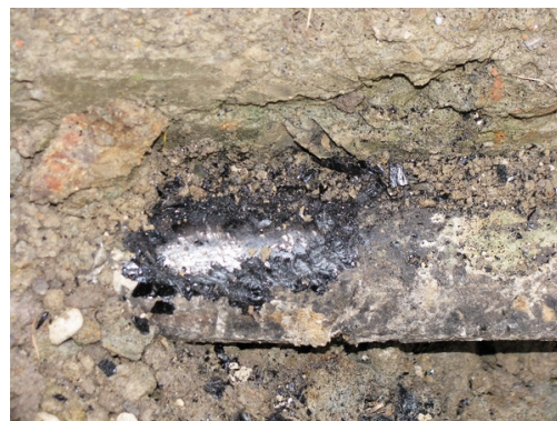
Рисунок 3 – Вигляд створеного наскрізного дефекту ізоляційного покриття
