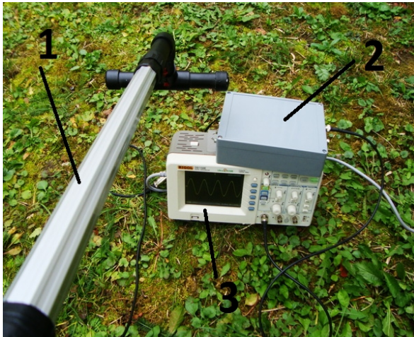
1 – магнітна антена; 2 – вимірювальний блок; 3 – цифровий двоканальний осцилограф
