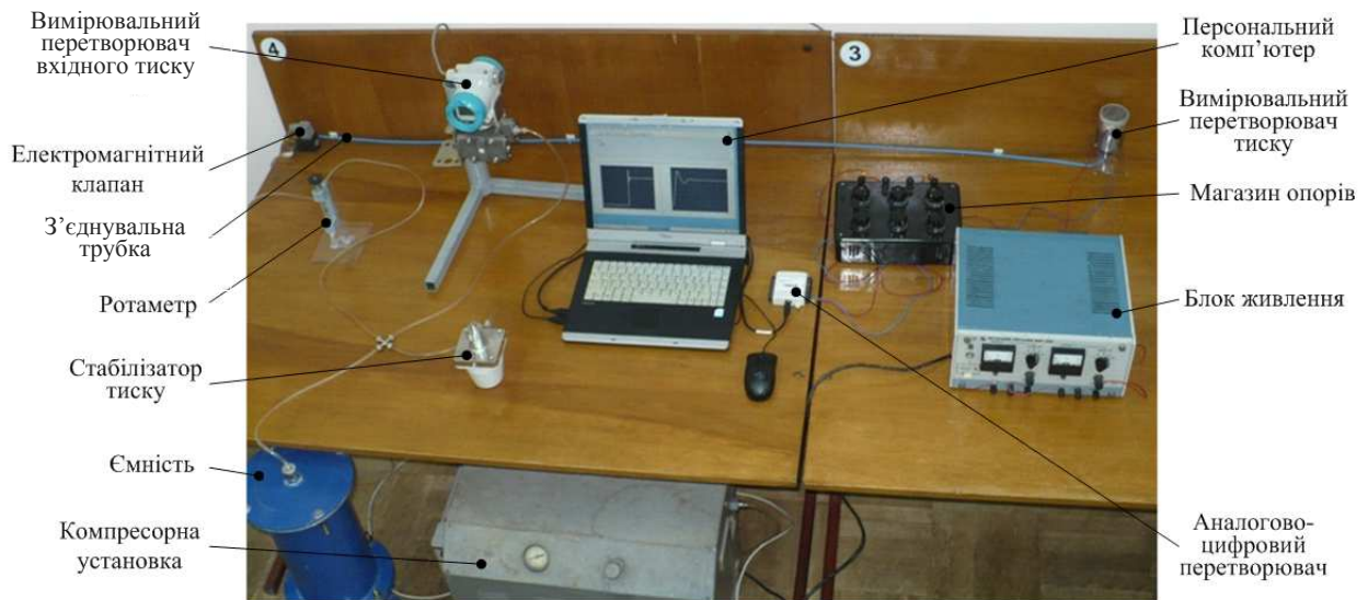
Рисунок 3 – Експериментальна установка для дослідження динамічних характеристик пневматичної лінії перетворювачів тиску
