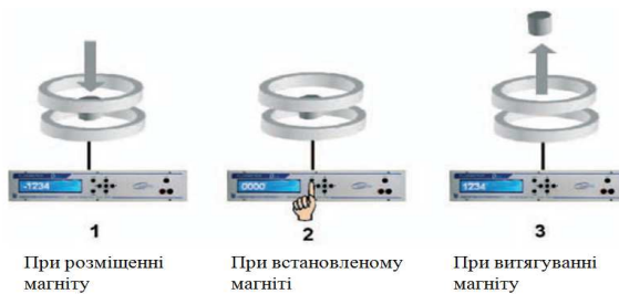
Рисисунок 2 - Схема контролю якості постійних магнітів індукційним методом
