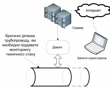
Рисунок 6 – Схема системи моніторингу технічного стану газопроводів (Times New Roman, 11 пт, bold, інтервали перед – 6 пт, після – 12 пт, посередині, без відступу)
