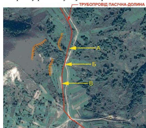
Рисунок 2. Досліджувана ділянка трубопроводу із підвищеним геодинамічним ризиком
