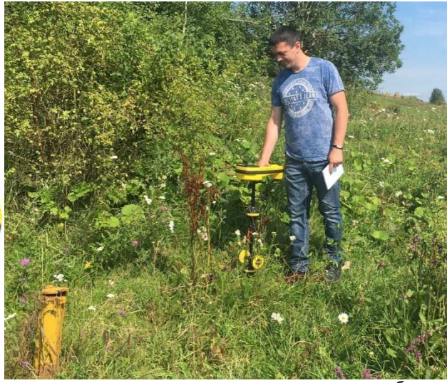
а. - Трасошукач SeekTech SR-60; б. - Польові дослідження Рисунок 3 – Визначення планового положення осі трубопроводу на поверхні землі
