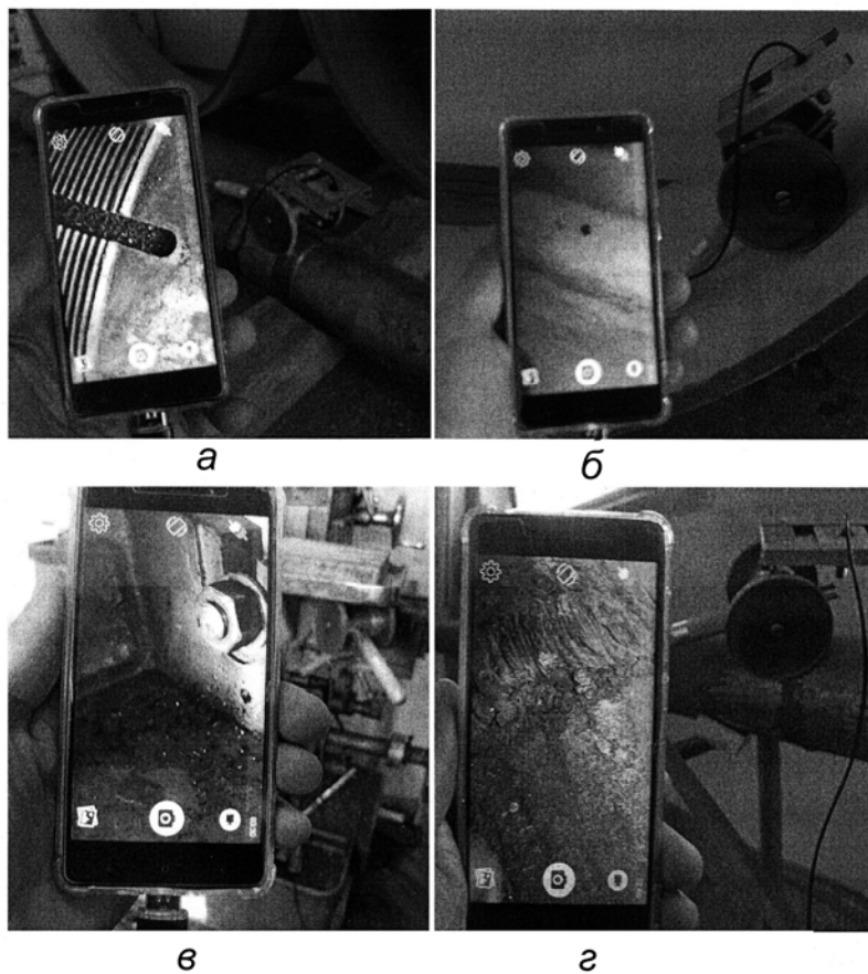
Рисунок 8 – Четыре фотографии смартфона Samsung, который держит в руках оператор, и устройства ВИК/ТВА с одной видеокамерой (рис. 5, 6), располагаемого на поверхности:
