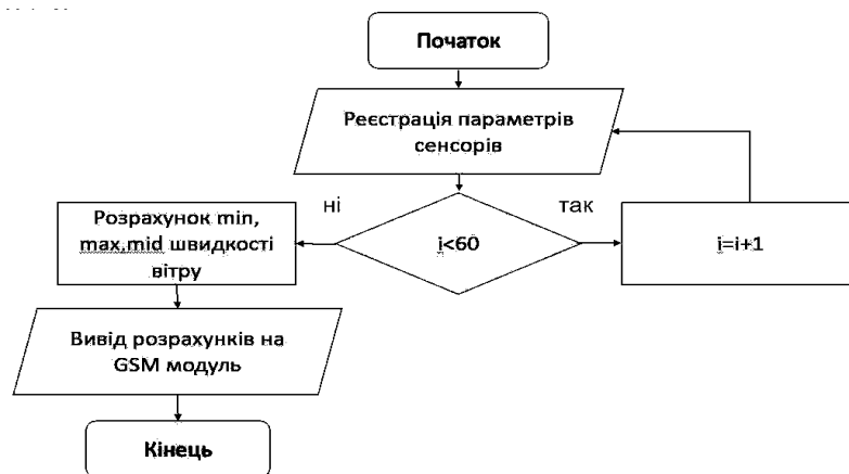
Рис. 3. Алгоритм реалізації процедури реєстрації параметрів вітрового потоку
