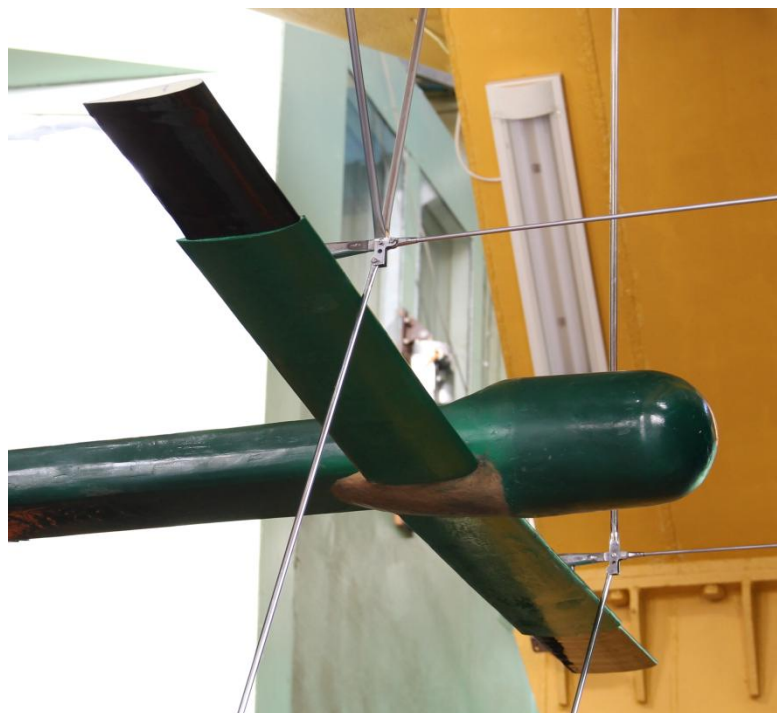
Рис. 3. Модель апарата з телескопічним крилом в АТ-1
