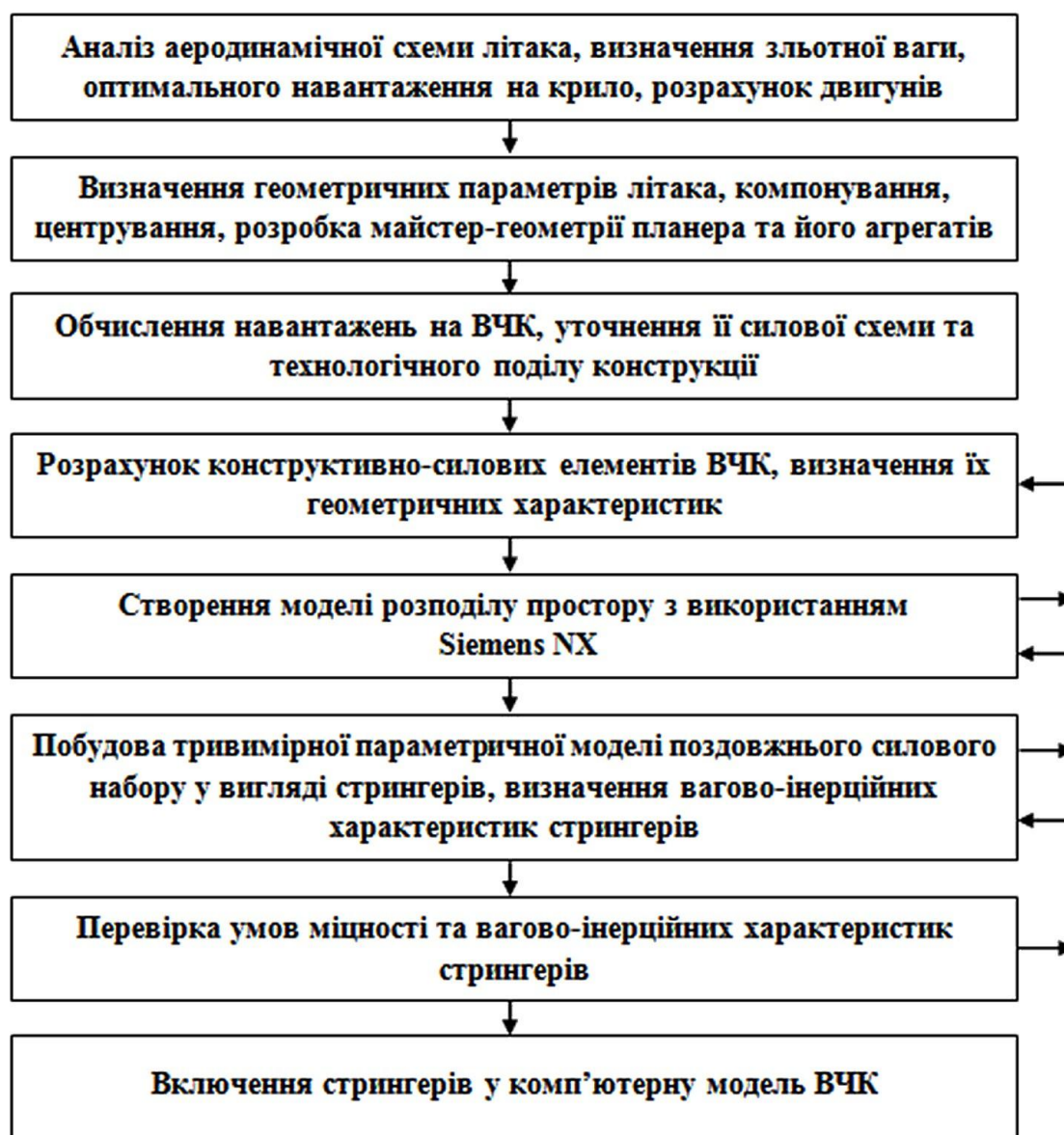
Рис. 1. Блок-схема проектування стрингерів ВЧК літака
