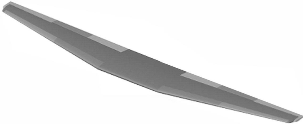
Рис. 2. Модель майстер-геометрії крила літака
