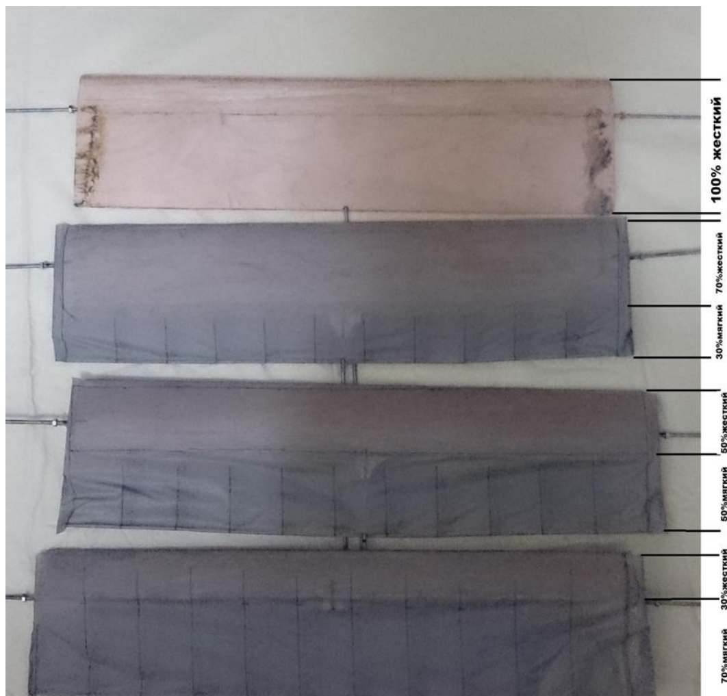
Рис. 2. Экспериментальные модели комбинированного крыла
