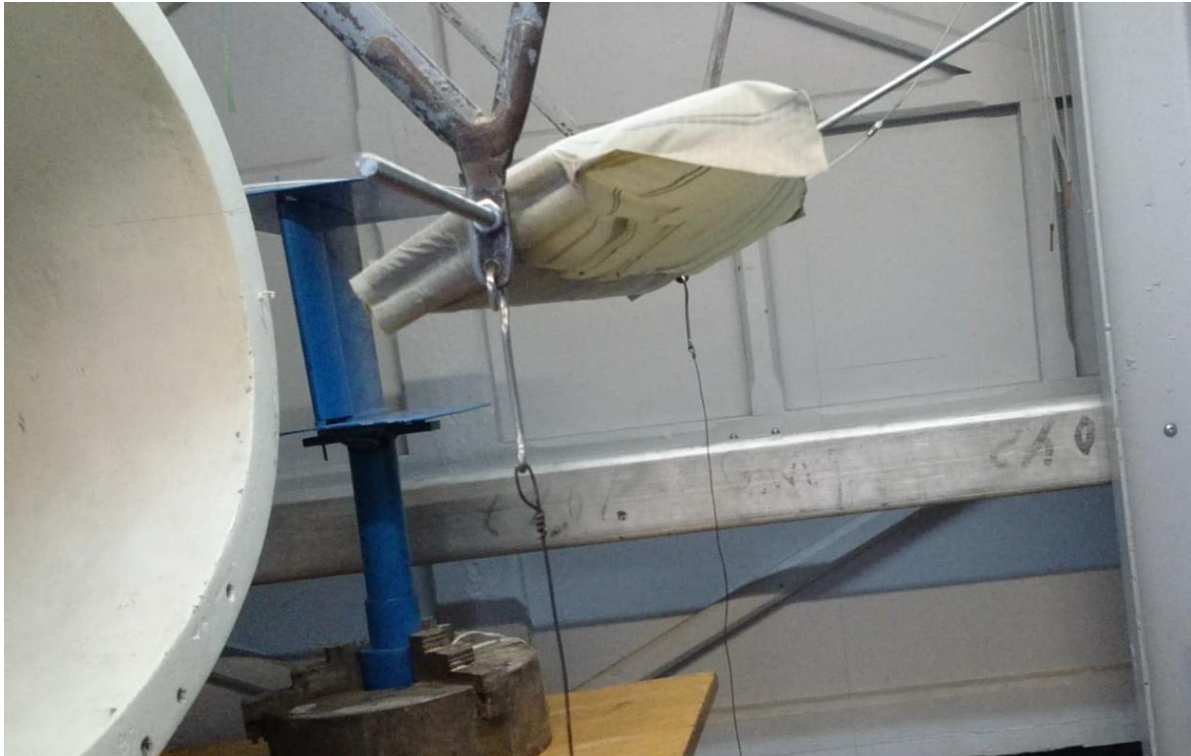
Рис. 9. Крыло 30% жесткое и 70% мягкое при наддуве \alpha = 32^\circ Зависимость C_y от угла атаки (рис. 4)
