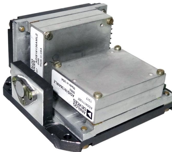
Рис. 1. Двухосный гиросtabilизатор с гироскопами ADIS16136
