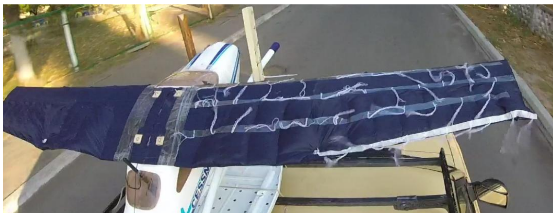
Рис. 8. Визуализация обтекания поверхности крыла методом шелковинок
