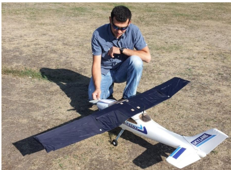
Рис. 3. Модель № 2 – Cessna 172 с гибридными крыльями
