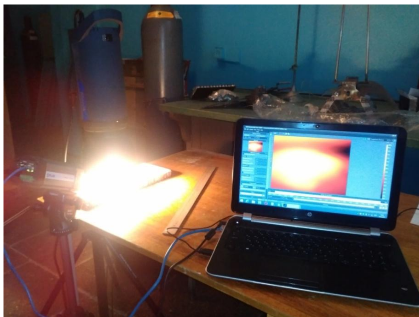
Рис. 3. Иллюстрация ИК нагрева лампой Meniksq-1200 (250 Вт)
