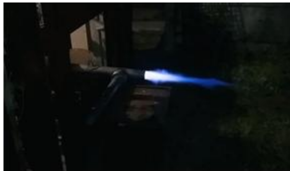
Рис. 10. Непроходження детонаційного фронту через сітку у разі швидкості 1905 м/с
