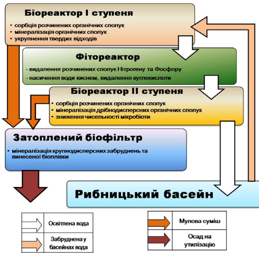
Рисунок 1 – Принципова схема технології біологічного очищення оборотної води УЗВ
