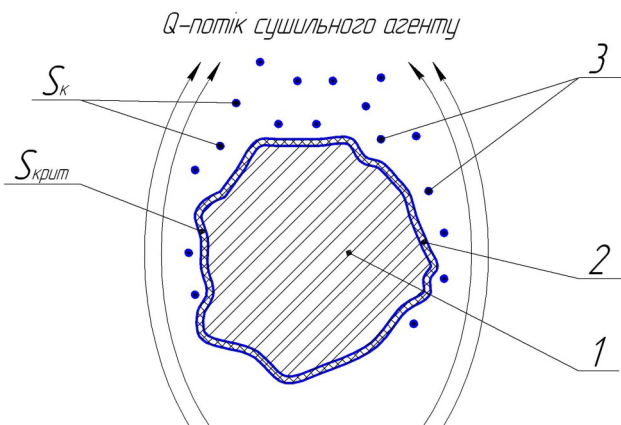
Рисунок 1. Частинка пасти діоксиду титану в потоці теплоносія
