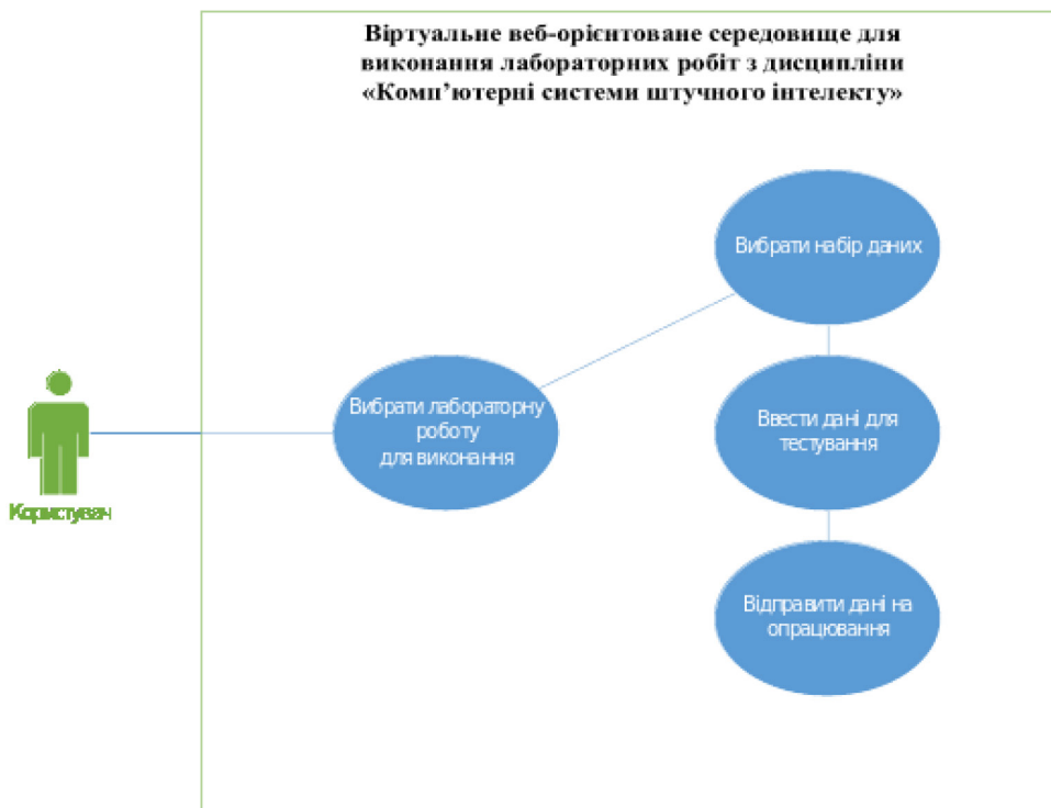
Рис. 1. UML сценарій використання віртуального веб-орієнтованого сервісу для виконання лабораторних робіт з дисципліни «Комп’ютерні системи штучного інтелекту»
