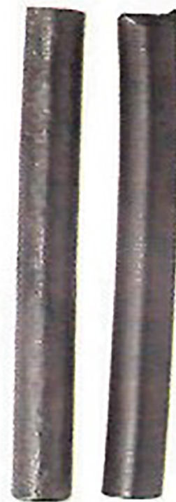
Рис. 3. Втомні поломки зігнутих штанг (вид з боку)
