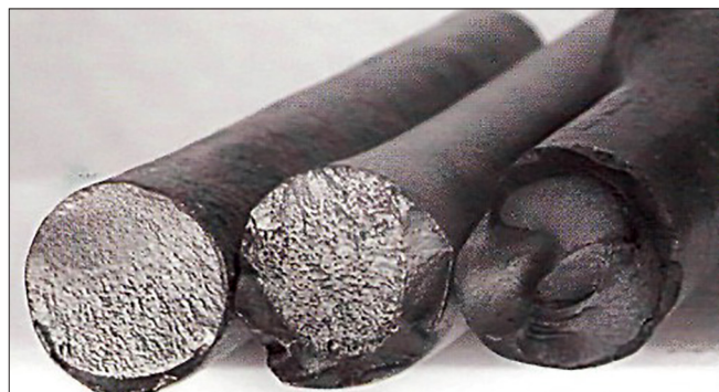
Рис. 2. Втомні поломки зігнутих штанг (вид з торця штанги)
