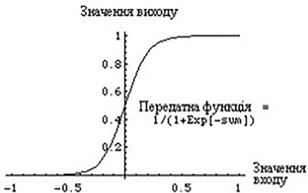
Рис. 3. Сигмоїдна передатна функція
