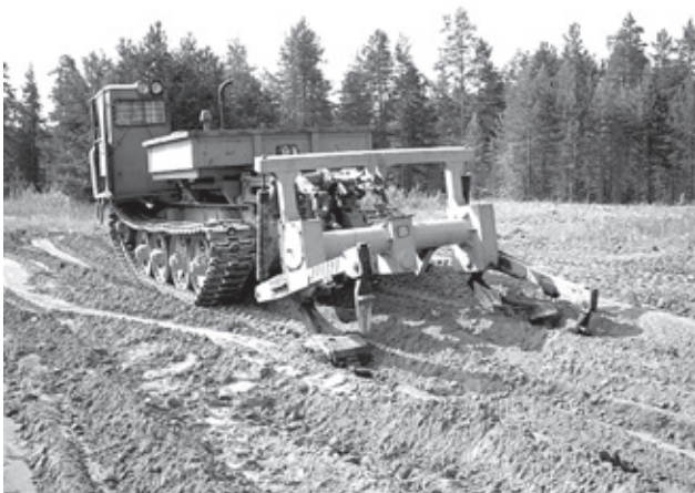
Рис. 1. Лункообразователь Л-2У в агрегате с трактором ЛХТ-55
