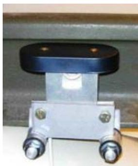
Рис. 2. Путевой датчик типа ШМП93 (НВЦ «Безопасность транспорта» Россия)
