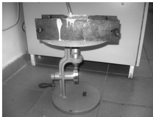
Рис. 2. Форма для отримання зразків бетону, розміщена на віброустановці
