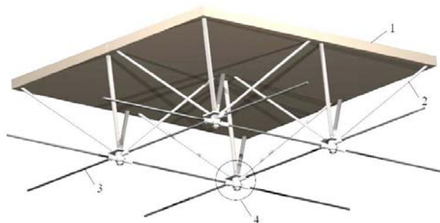
Рис. 1. Фрагмент збірної сталезалізобетонного структурно-вантового покриття 1 – армоцементна плита; 2 – елементи сталевий структурної решітки; 3 – гнучкі елементи нижнього поясу; 4 – вузол з'єднання гнучких елементів нижнього поясу
