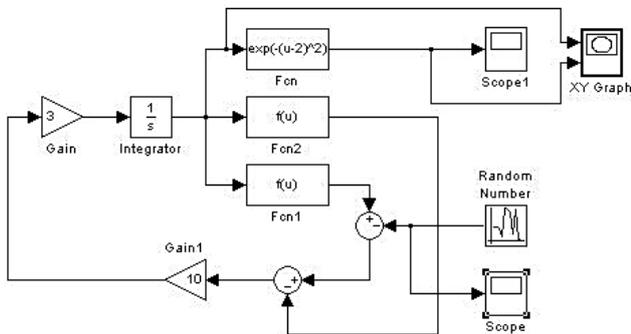
Рис. 9. Схема моделирования градиентной процедуры поиска максимума
