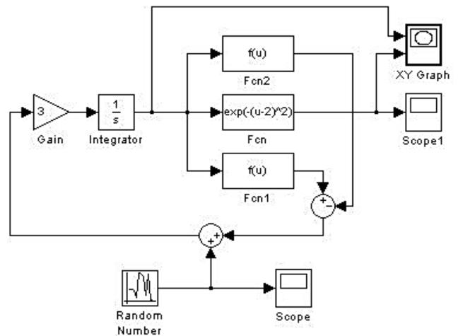
Рис. 11. Схема моделирования процедуры модифицированного симплекс метода
