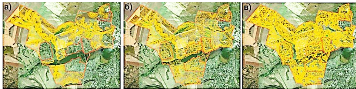
Рис. 5. Межа та горизонталі Богдашівської сільської ради: а) відвекторизовані вручну, б) побудовані за SRTM, в) побудовані за ASTER
