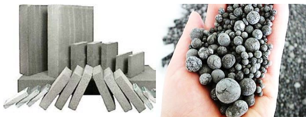
Рис. 7. Утепление с помощью плит пеностекла
