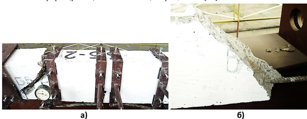
Рис. 4. Просторова тріщина кручення на прикладі балки Б 5-2: а) загальний вид балки в експериментальній установці; б) просторовий похилий переріз балки по тріщині
