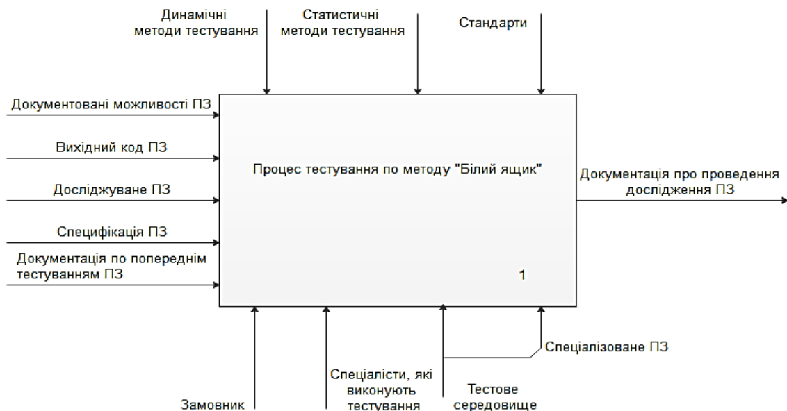
Рис. 1. Контексна діаграма процесу тестування програмного забезпечення методом «Білий ящик»
