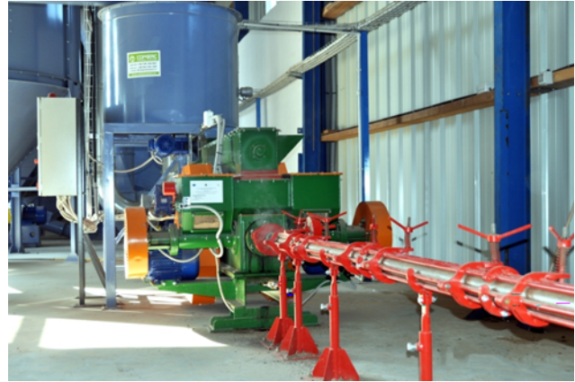
Рис. 7. Приклад конструкції шнекового преса [31]
