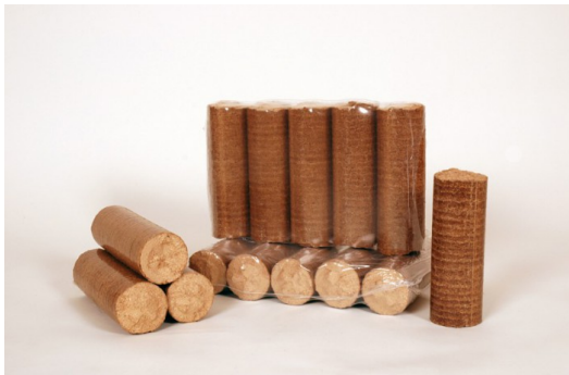
Рис. 12. Брикети, отриманий з пресів з відкритою камерою [29]
