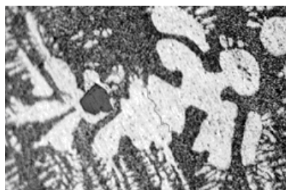
Рис.3. Соприкасающиеся кристаллы эвтектического алюминия различного происхождения, \times 400 .
