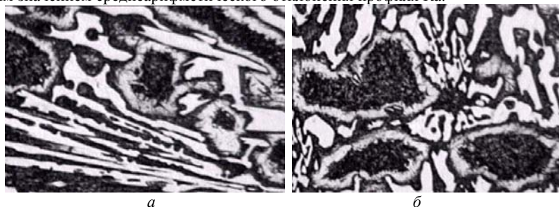
Рис. 1. Микроструктура чугуна в литом состоянии: a – продольное и б – поперечное сечение эвтектических колоний, \times 500 .
