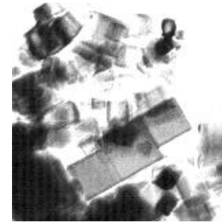
Рис. 4. Электронномикроскопическое изображение наночастиц карбонитрида титана, x50000.
