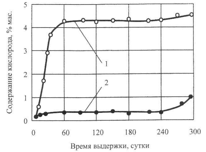
Рис. 2. Влияние времени выдержки наномодификатора в негерметичных емкостях на содержание в нем кислорода: 1 – неплакированный; 2 – плакированный.
