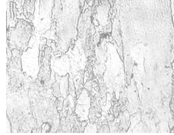
Рис. 1. Микроструктура промежуточного слоя на глубине 6,5 мм от поверхности листов стали 06Г2МТФБР после горячей прокатки с конечной температурой 720 °С ( \times 400 ).
