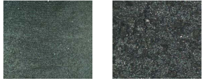
Рис. 4. Макроструктура нанесених металокерамічних покриттів: а,б – зона 2; а – х 6,5; б – х 50.
