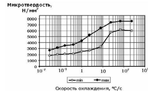
Рис. 3. Микротвердость стали 42Cr4Mo2 после нагрева 850 °С – 10 мин и охлаждения с различными скоростями.
