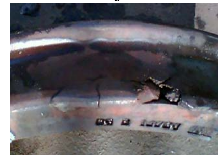
Рис.1. Примеры формирования дефектов в зоне фаски обода (наплыв – а; поверхностный откол металла – б).
