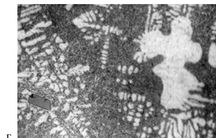
Рис. 5. Структурные условия перехода от раздельного к кооперативному росту эвтектики Ж \rightarrow \alpha\text{-Al} + \beta\text{-Si} ; а, б \times 200 ; 1, 5; а, в \times 400 ; 1, 5
