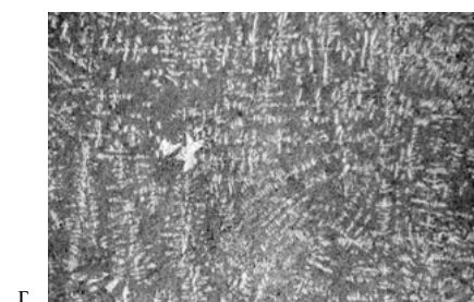
Рис. 4. Последовательные сечения кристаллов алюминия и кремния, образовавшихся по механизму отдельного роста эвтектики, 1–3 с от начала эвтектического превращения, \times 200
