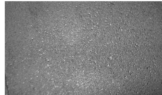
Рис. 3. Поверхность образца после дробеструйной обработки.
