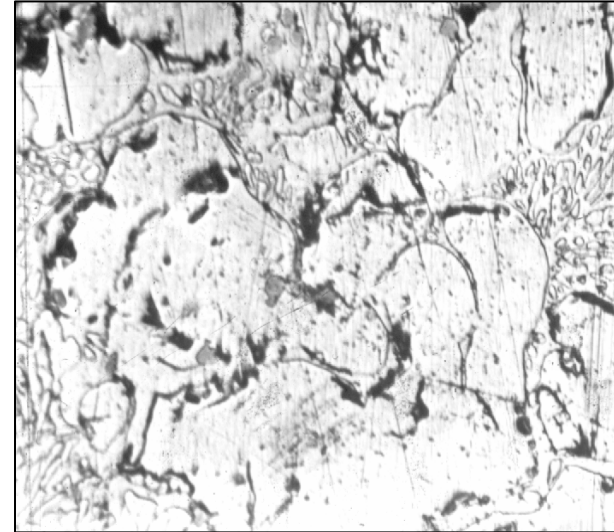
Рис. 2. Микроструктура сплава Fe–Ti полученного методом ЭШВ после травления, \times 300 .
