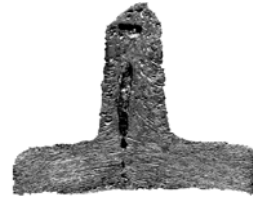
Рис. 6. Вид образца газара при встречных фронтах кристаллизации и параметрах процесса P_n = P_{кр} = 0,1 МПа / Fig. 6. Kind of the sample gazar at counter fronts of crystallisation and parametres of process P_s = P_{cr} = 0,1 МПа
