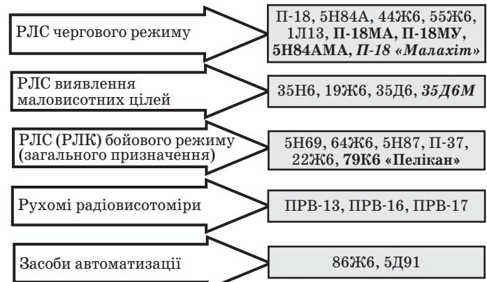
Рис. 2. Наявна радіоелектронна техніка РТВ
