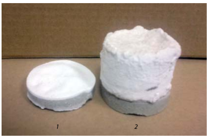
Рис. 2. Фільтраційна кірка безглинистого розчину, не обваженого (1) і обваженого баритом до густини 1820 кг/м 3 (2), після вимірювань при T = 140\text{ }^{\circ}\text{C} та P = 5\text{ МПа}
