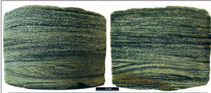
Рис. 1. Алевро-пісковий кварцовий, із карбонатно-апоглинистим (карбонатно-гідролюдистим) цементом, глауконітумісний, сульфідизований (зразок GRB-1). Вигляд породи у розрізі вздовж осі керна. Світла частина породи – теригенний кварцовий матеріал алевро-псамітової розмірності, скраплений карбонатно-гідролюдистим та, частково, рудним цементом. Текстура псевдошарувата, структура алевро-псамітова
