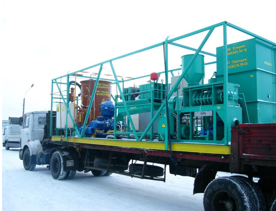
Рис. 7. Відвантажений споживачеві міні-завод продуктивністю 2 тонни дизельного біопалива на добу
