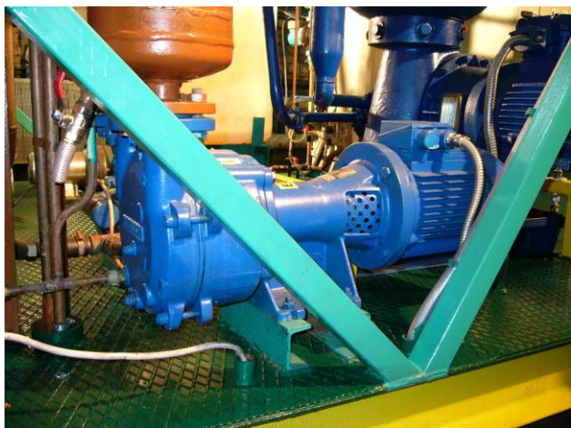
Рис. 4. Вакуумний насос для осушування дизельного біопалива
