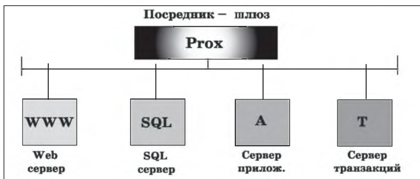
Рис. 2. Схема подключения сетевых и несетевых СУБД при организации HTTP-SQL сервера
