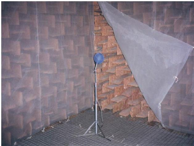
Рис. 1. Ревербераційна камера для вимірювання повітряного і ударного шуму.
