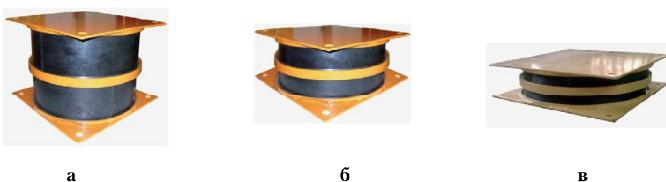
**Рис. 4.** Дослідні зразки конструкцій гумометалевих сейсмоізоляючих блоків: а) 2×120 мм; б) 2×70 мм; в) 2×50 мм.
