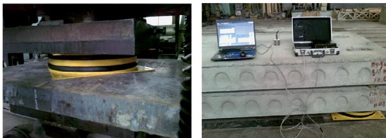
**Рис. 5.** Випробування гумових сейсмоізоляючих блоків, проведенні в ДП НДІБК:
