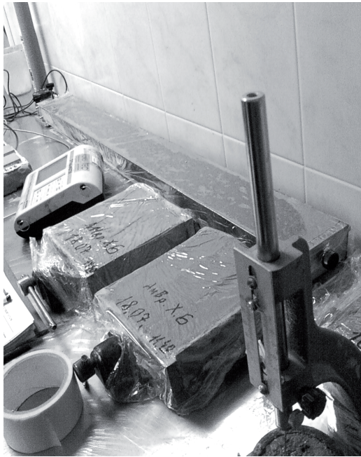
Рис. 1. Лінійка з пристроєм автоматичної реєстрації деформацій та форми з цементно-піщаним розчином.
