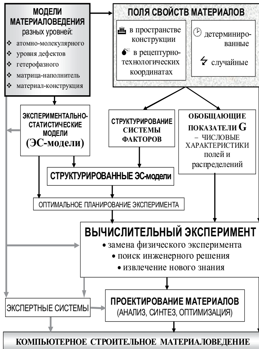
Рис. 3. Схема включения концепции полей свойств и ЭС-моделей в компьютерное строительное материаловедение.
