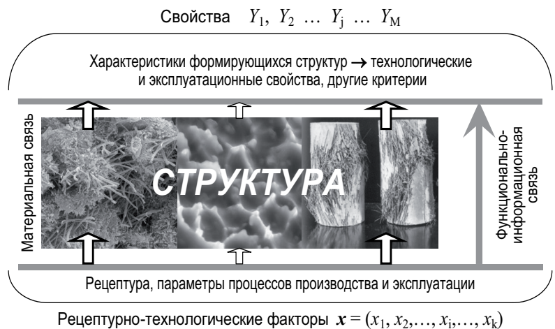
Рис. 1. Схематическое изображение связей при рассмотрении цепи «рецептура, технология → структура → свойства».
